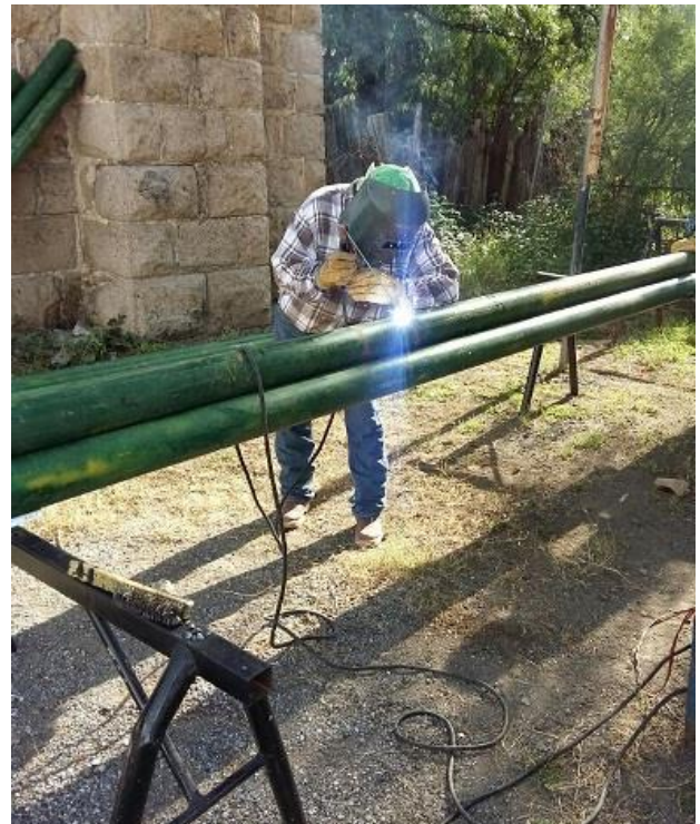
Fabricación de postes para ampliaciones de Alumbrado Público.
