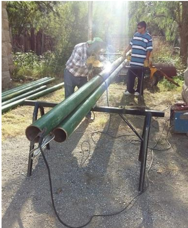
Fabricación de postes para ampliaciones de Alumbrado Público.
